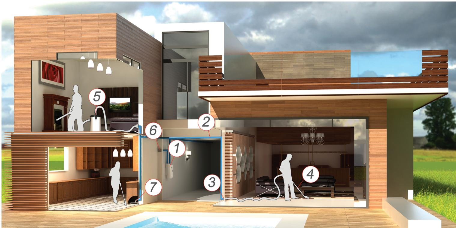
Центральный агрегат (1) размещен стационарно в одном из подсобных помещений. При включении уборочного шланга в клапан-розетку центральный агрегат создает вакуум в системе.
